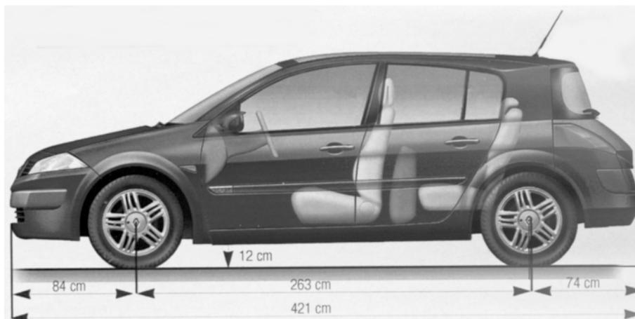
Sur ce véhicule, on relève 680kg sur le train avant et 485 kg sur le train arrière.
