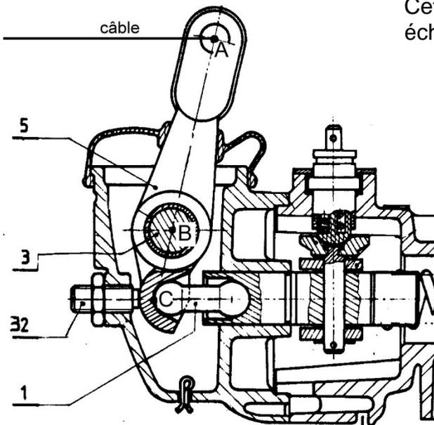
Cette centrale de freinage représentée partiellement échelle 1 :2 est commandée par câble.
