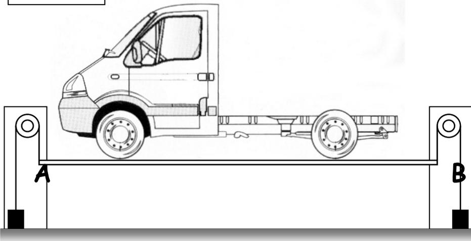
Ce véhicule utilitaire a un poids de 12000N sur le train avant et 6000N sur le train arrière.
