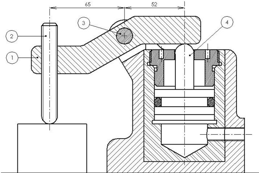
La bride hydraulique représentée ci-contre à l'échelle 1:2 est alimentée à une pression de 1Mpa.
