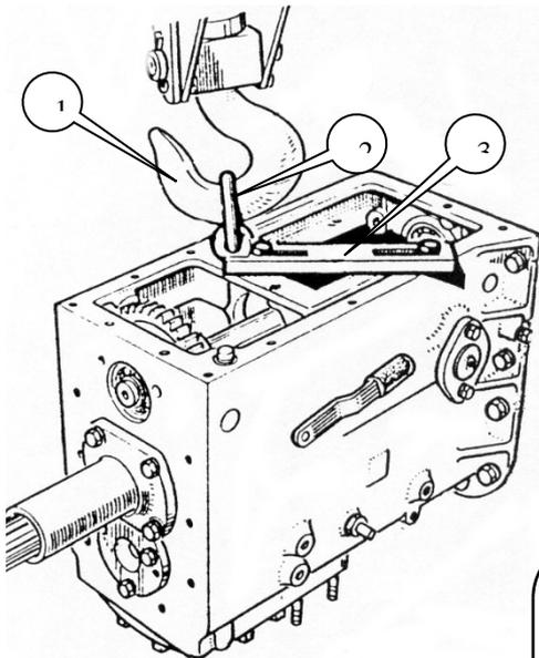
On soulève une boîte de vitesses de tracteur (60kg) avec un palan par l'intermédiaire d'un crochet 1, d'un maillon 2 et d'une plaque 3.
