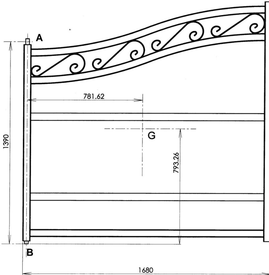
Ce vantaux de portail (1), d'un poids de 300N est articulé en A sur un pilier (0) et en B au sol (0).
