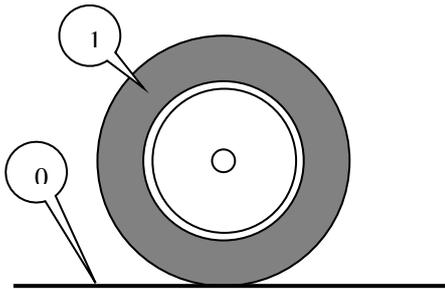
La roue 1 de masse 10kg est posée sur le sol 0 au point P. Faites le bilan des forces qui s'exercent sur cette roue :
