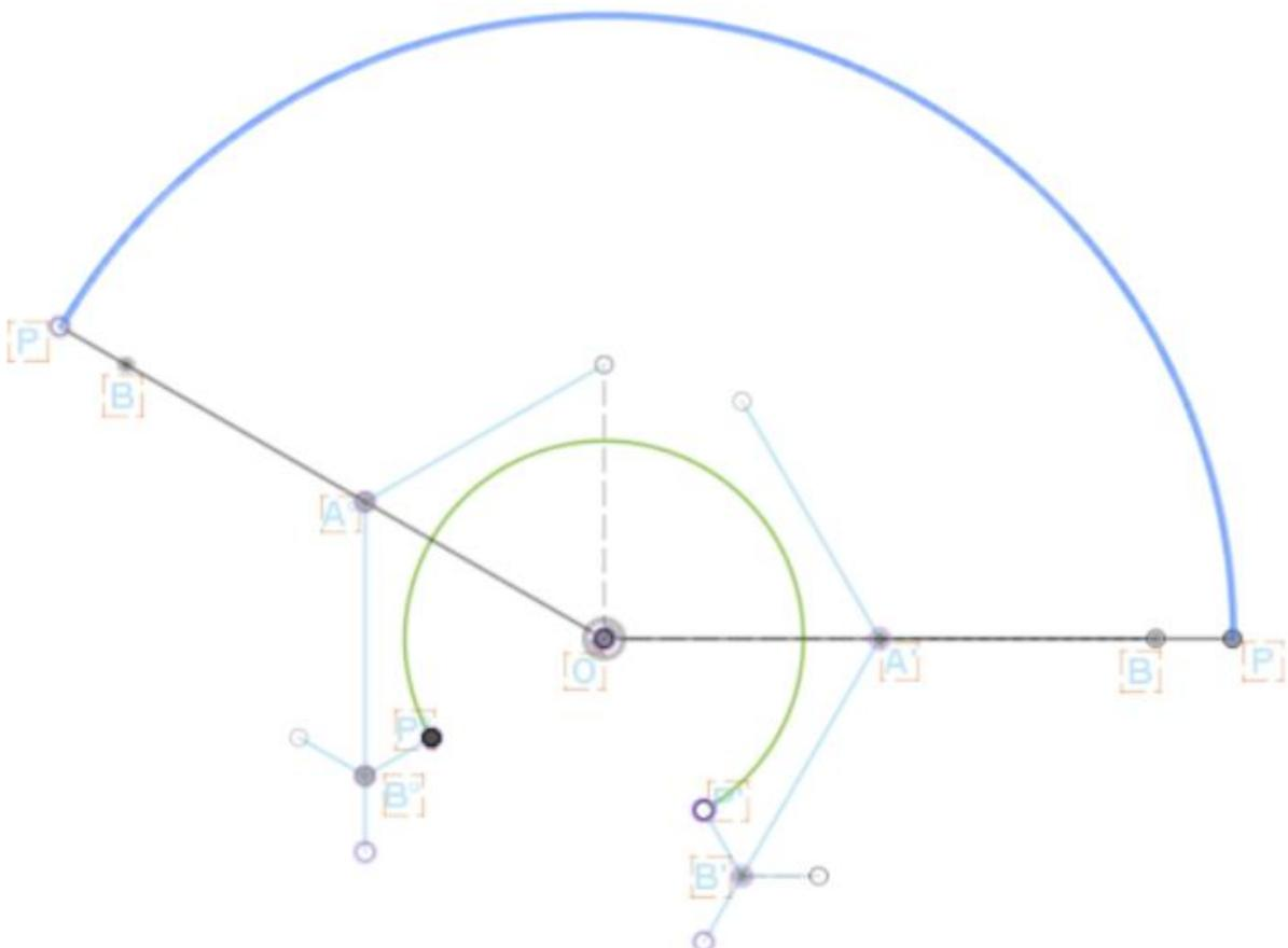
L'alignement successif des bras AB et BP détermine l'amplitude maximale de l'aire de travail.
