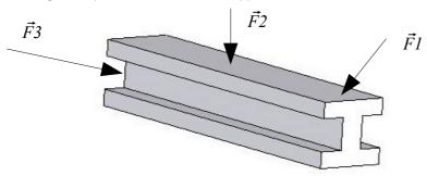
Afin de déterminer à quel type de sollicitations est soumise cette poutre, on la divise virtuellement en deux tronçons, et on « isole » la partie gauche.
