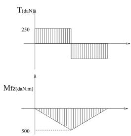
Les diagrammes ci-contres montrent que la poutre est soumise à du cisaillement et à de la flexion. Il s'agit donc de <u>flexion simple.</u>
