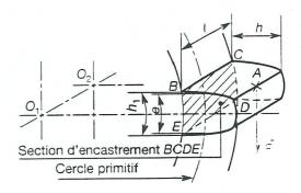
La dent est modélisée comme une poutre encastrée dans le moyeu de la roue dentée.
