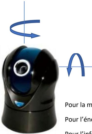
Un des modèles de cette société est une webcam motorisée pilotable à distance à deux axes de rotation (voir figure ci-contre).
