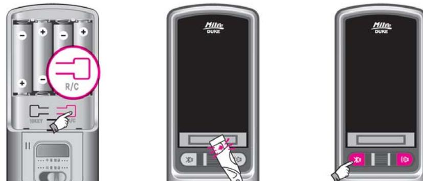
Ouvrez la capot des piles et pressez brièvement le bouton [R/C]
