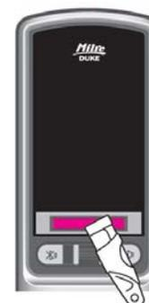
Mettez en contact le plat de la clé numérique enregistrée à la zone de contact de la partie extérieure de la serrure électronique.
