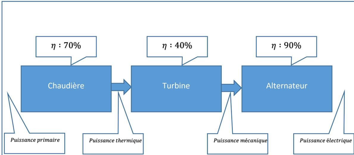
Chaîne d'énergie d'une centrale nucléaire à eau pressurisée :
