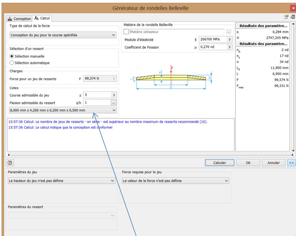
Changer le type de rondelle en agissant sur l'ascenseur puis cliquer sur calculer, rechercher la rondelle limitant l'encombrement au maximum et répondant aux contraintes.
